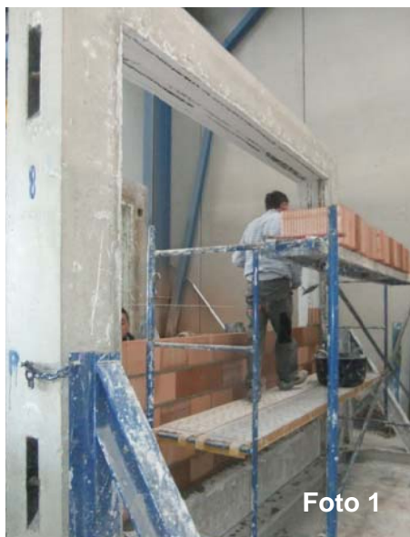
Fotos 1 y 2: Montaje de fábrica de pieza de arcilla cocida de 11,5
