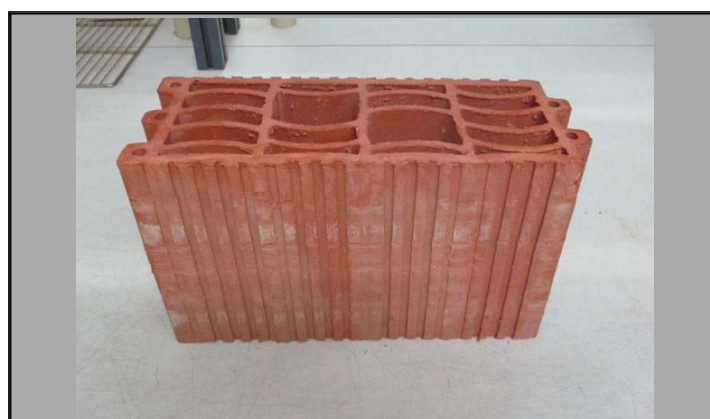
Fotografía 1: Imagen de una de las piezas de arcilla cocida ensayadas
